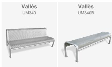
Panchina bilaterale realizzata con laterali in tubolari di acciaio curvati di Ø40 mm, con seduta e schienale ergonomici in modulo continuo realizzati in lamiera di acciaio forata spessore 2 mm, con fori circolari alternati del diametro pari a 7 mm, trattata con Ferrus, un processo protettivo che garantisce un'ottima resistenza alla corrosione.
