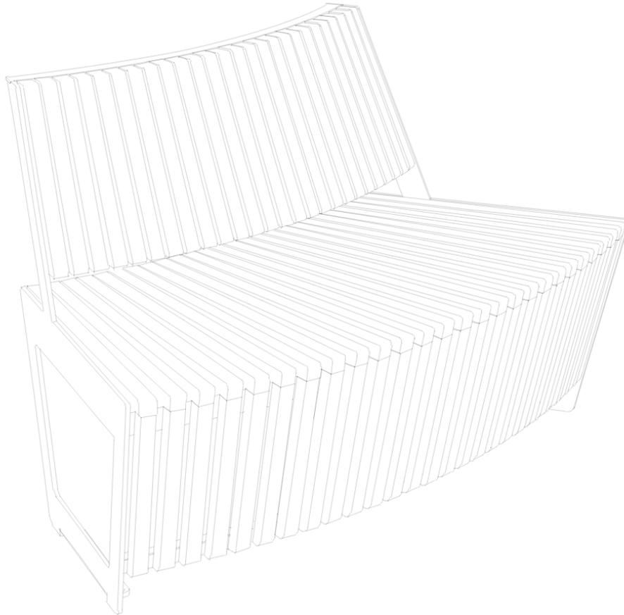
Banc courbe design compatible avec les autres éléments de la collection RIGA pour configurer un système de mobilier modulaire permettant de personnaliser l'espace. Structure en acier (traité avec le procédé Ferrus, le protecteur triple couche pour le fer, qui garantit une résistance optimale à la corrosion) finition RAL 7006 et bois dur traité avec une huile protectrice.
