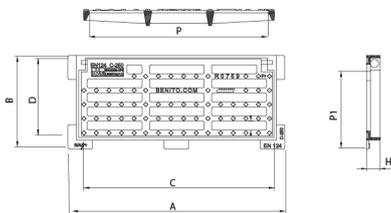
Abatible D4 est conçue pour supporter un trafic moyen. Idéale pour installation sur voies ayant un TMJ de 1.000 - 20.000, notamment chaussées de route, accotements stabilisés et aires de stationnement pour tout type de véhicule.
