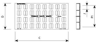
Dry est conçue pour supporter un trafic intense. Idéale pour installation sur voies ayant un TMJ de 1.000 - 20.000, notamment sur chaussées de route, accotements stabilisés et aires de stationnement pour tout type de véhicule.
