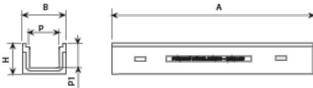
**Caniveau HRM + Mecaligne** pensée pour supporter une circulation modérée. Parfaite pour une installation sur des voiries ayant un TMJ de 500 à 1.000, notamment sur les bas-côtés et caniveaux.
