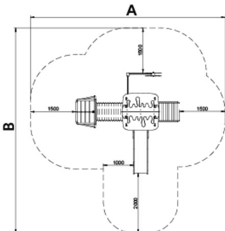
Collection de jeux pour enfants **fabriquée avec des matériaux sans entretien** : poteau extrudé en aluminium et polymère, marches en aluminium d'une seule pièce et plateformes en polymère antidérapant. L'utilisateur trouvera des jeux inclusifs sur l'ensemble de la structure.
