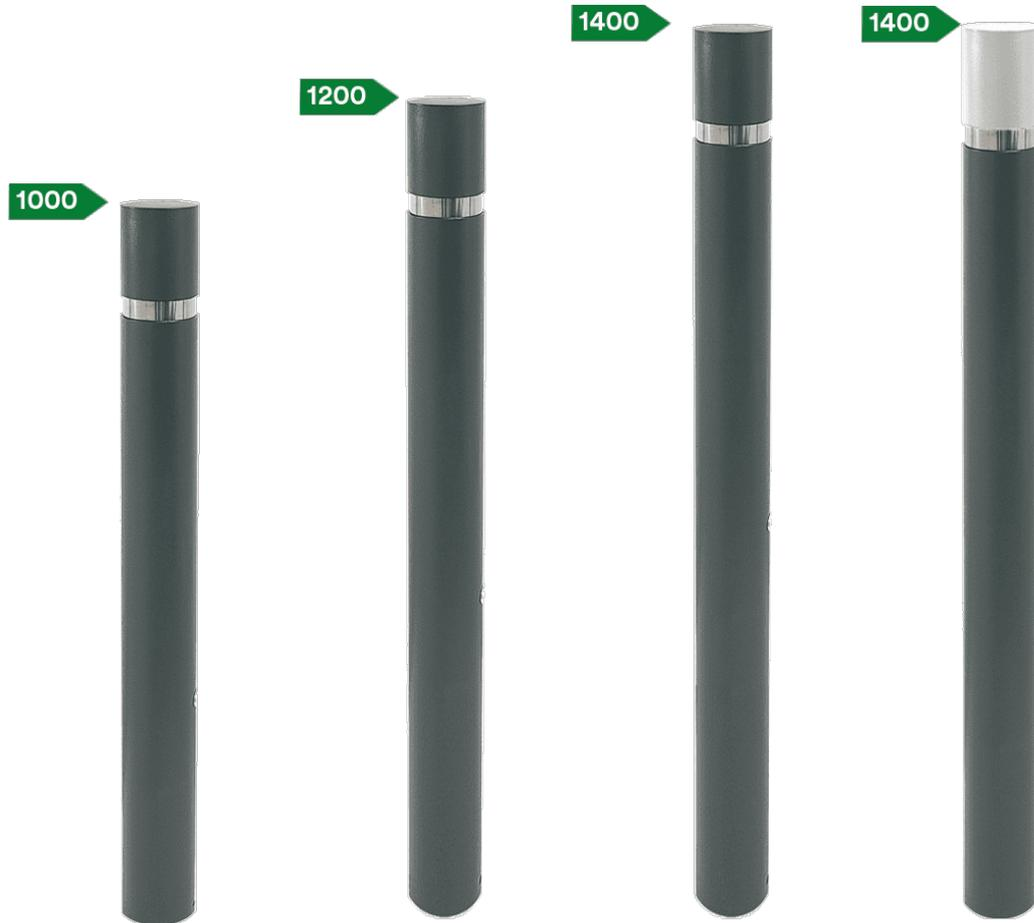
Borne fabriquée en acier avec traitement Ferrus, procédé qui protège le fer et garantit une résistance optimale à la corrosion. Le traitement Ferrus consiste en trois couches appliquées à la suite du nettoyage de toutes les impuretés par grenailage : zingage, couche époxy et une couche de peinture poudre polyester coloris noir forge. Anneau enjoliveur en acier inoxydable.
