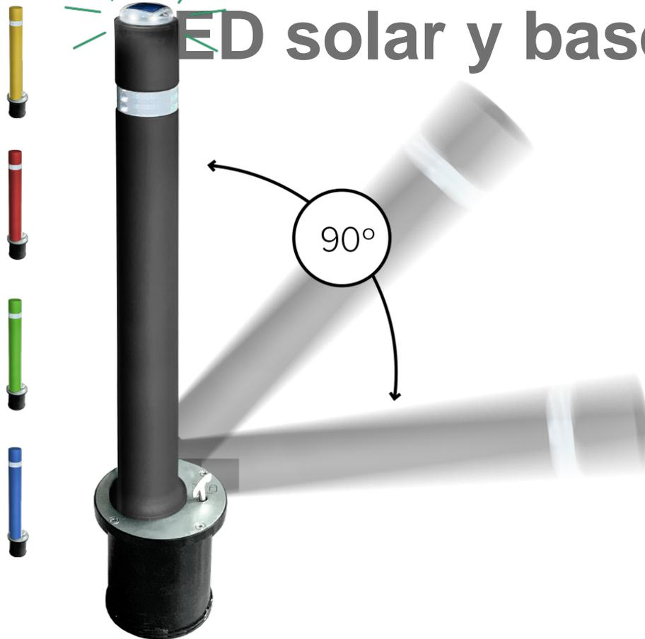
Beweglicher Poller mit Solar-LED-Leuchtring aus schwarzem Polyurethan, wahlweise in rot, blau, gelb oder grün. UV-geschützt, ein Reflektorenband. Mit aufschraubbarer Bodenplatte Beständig gegen Aufprall von Fahrzeugen, kehrt zu 100% in seine Originalform zurück. Hält bis zu 1500 Biegungszyklen zu 45° und 50 Zyklen zu 90° schadenfrei aus. Klassifizierung "E" Feuerbeständigkeit gemäß UNE-EN 13501-1:2007+A1:2010. Beständig bis -50° gemäß Norm UNE ISO 812. Wartungsfrei.
