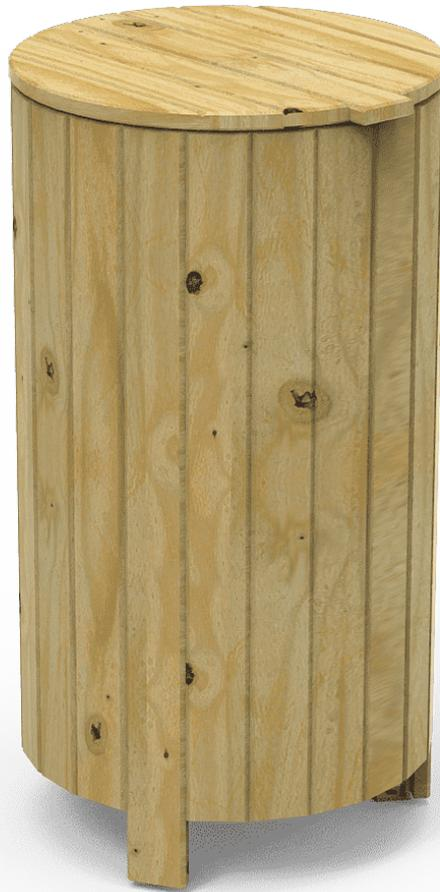
Papelera fabricada en madera de pino con tratamiento autoclave a vacío-presión clase 4 contra la carcoma, termitas e insectos. Acabado color natural. Tornillería en acero inoxidable. Anclaje recomendado: Mediante tres pernos de expansión de M8 según superficie y proyecto.
