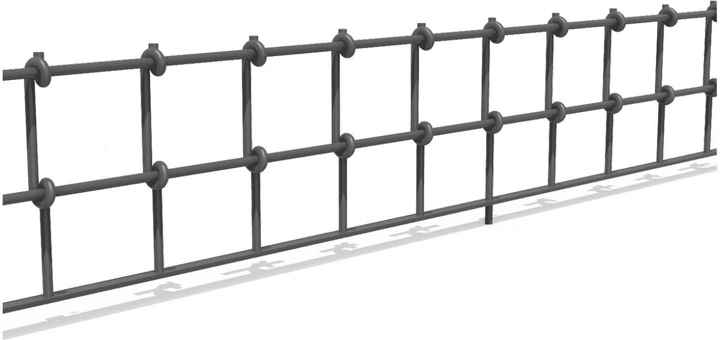
Valla fabricada íntegramente en acero Ø16 mm y pletina 30 x 6 mm, con estructura reforzada tratada con Ferrus, un proceso protector del hierro, que garantiza una óptima resistencia a la corrosión.
