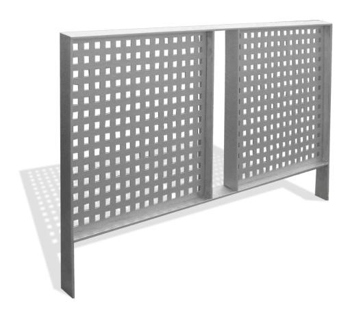
Valla fabricada en acero con tratamiento Ferrus, un proceso protector del hierro, que garantiza una óptima resistencia a la corrosión. El tratamiento Ferrus se compone de tres capas que se aplican después de limpiar toda la suciedad y las impurezas mediante granallado y consiste en un zincado, seguido de una capa de imprimación epoxi y un último recubrimiento de pintura poliéster en polvo color gris plata RAL 9006.
