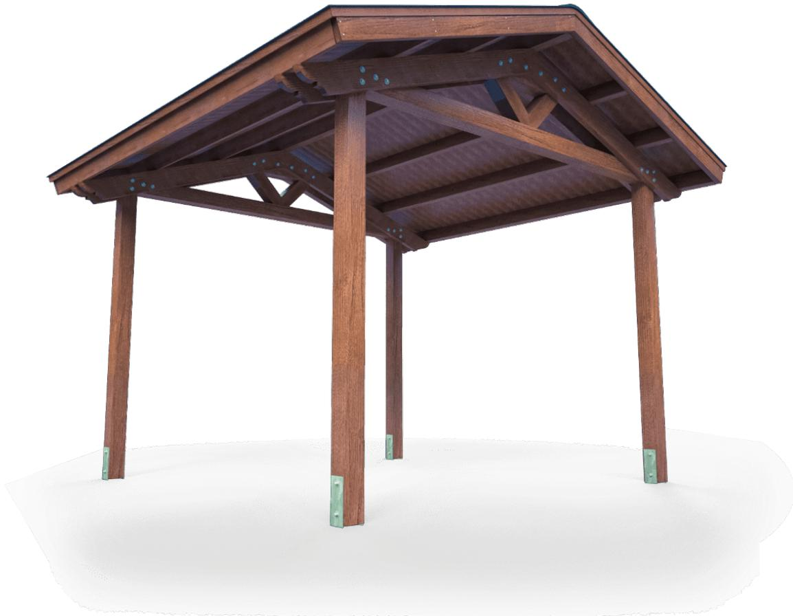
Pergola autoportante con tetto a 2 falde 4000 x 4000 in legno di pino Oregon Europeo (Douglas): pilastri 120 x 120 mm, travi 170 x 45 mm, travetti 140 x 45 mm e listelli con incastro maschio / femmina 115 x 21 mm. Finitura Lasur, 100% naturale a base di oli e resine vegetali, con protettore ai raggi UV color rovere dorato.
