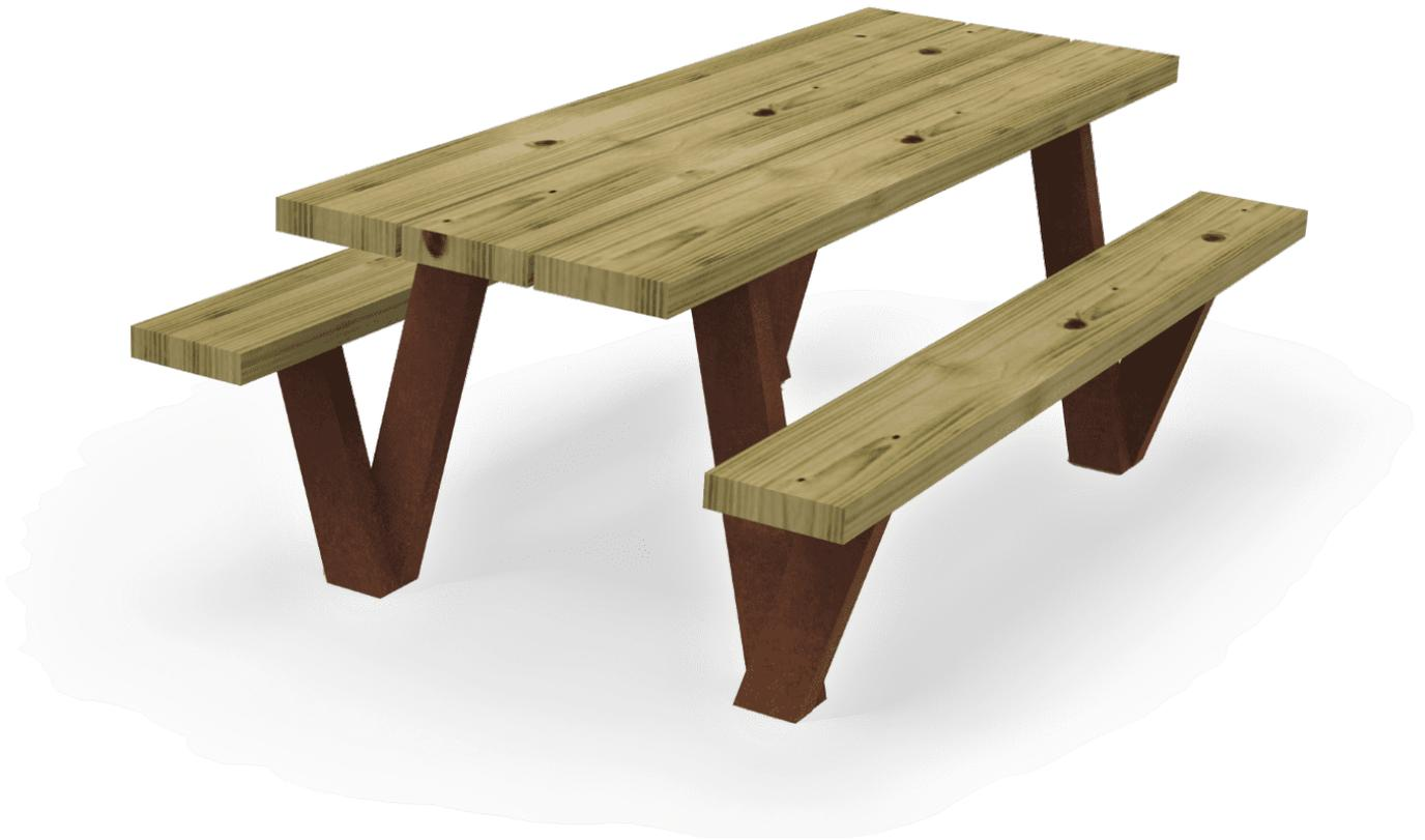
Gruppo Picnic realizzato con piedi posti a forma di "V" rovesciata in tubolari di acciaio corten 50x100 mm. Doghe di legno di pino trattato in autoclave, rischio classe IV, con sezione di 210 x 50 mm, con protezione contro tarli, termiti ed insetti. Viteria in acciaio inossidabile.
