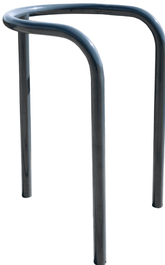
Protettore per alberi o pali realizzato in acciaio con trattamento Ferrus, un processo protettivo che garantisce un'ottima resistenza alla corrosione. Il trattamento consiste in una granigliatura per eliminare tutti i tipi di sporcizia ed ossidazioni, un bagno elettrolitico, seguito da una mano di primer epossidico ed una mano finale di vernice a polvere di poliestere colore grigio RAL 7016.
