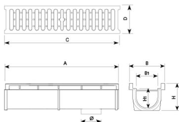
**Canal + Mecaline D4 è progettato per sopportare un traffico medio.** Perfetto per essere installato su strade con un ADT di 1.000-20.000, specialmente per carreggiate stradali (incluso le vie pedonali), banchine e le aree di sosta per tutti i tipi di veicoli.
