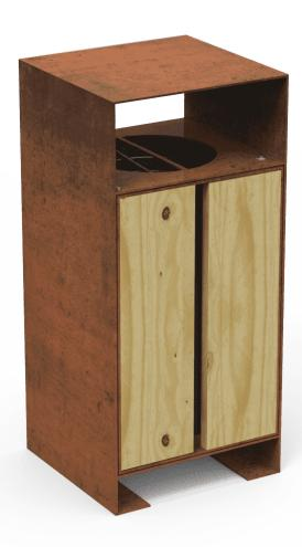
Portarifiuti realizzato con telaio in lastra di acciaio Corten con spessore 6 mm e ante con doghe di legno di pino trattato in autoclave, rischio classe IV, con protezione contro tarli, termiti ed insetti. Con cestello interno in acciaio galvanizzato.
