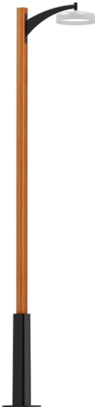
Palo con base realizzata in acciaio S-235-JR galvanizzato. Finitura con rivestimento in poliuretano testurizzato colore antracite. Palo realizzato in legno duro tropicale trattato con fungicida, insetticida e protezione impermeabile. Rinforzato internamente con un tubo quadrato in acciaio galvanizzato da 60mm.
