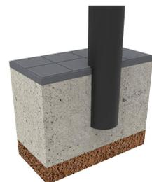
Ancoraggio mediante fondazione in CLS.
