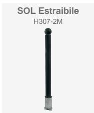
Dissuasore realizzato in acciaio con elettroforesi, primer epossidico e finitura verniciata a polveri di poliestere in colore grigio RAL 7016. Ancoraggio raccomandato: mediante fondazione in CLS con barre filettate.
