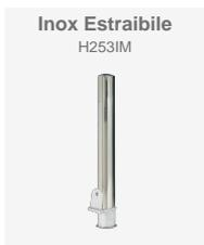
Dissuasore estraibile realizzato in acciaio inossidabile AISI-304 con finitura lucido brillante. Ancoraggio raccomandato: mediante fondazione in CLS con barre filetate.
