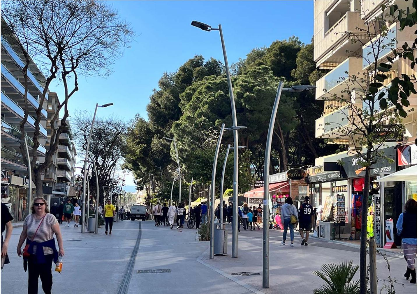
La ville côtière de Salou a installé des dizaines de points lumineux Ter de 7 mètres avec des projecteurs Milan XXL RGBW et des luminaires Milan S40 de 4 mètres sur l'avenue Carles Buïgas. Ils sont complétés par des mâts cylindriques. Tous les points lumineux comprennent la technologie LED et sont contrôlés avec le système de gestion à distance DMX via un écran tactile pour générer des vagues de couleur sur l'une des principales artères commerciales de la ville.
