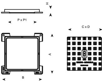
Hidra C2 est conçu pour supporter un trafic modéré. Idéal pour installation sur voies ayant un TMJ de 500 à 1.000, notamment sur accotements et caniveaux.
