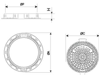
Compart D4 est conçu pour supporter un trafic moyen. Idéal pour installation sur voies ayant un TMJ de 1.000 - 20.000, notamment sur chaussées, accotements stabilisés et aires de stationnement pour tout type de véhicule.
