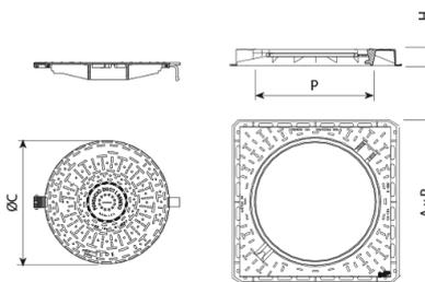
**Hexa est conçu pour supporter un trafic moyen.** Idéal pour installation sur voies ayant un TMJ de 1.000 - 20.000, notamment sur chaussées, accotements stabilisés et aires de stationnement pour tout type de véhicule.
