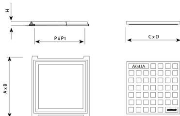
Fabriqué en fonte ductile à graphite sphéroïdal conformément aux normes ISO 1083 (type 500-7) et EN 1563.
