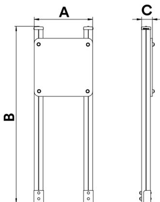
**Structure, Bois lamellé :** bois de pin scandinave traité en autoclave classe IV. Finition avec 2 couches de peinture Lasur. Face aux intempéries, le bois lamellé peut présenter de petites fentes qui ne réduisent pas sa durabilité. La résine et les noeuds sont naturels.
