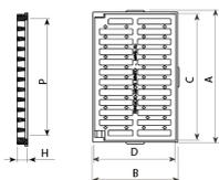
Imbornal está diseñada para soportar un tráfico suave. Perfecta para instalar en vías con una IMD de < 500, especialmente en arcnos y cunetas.
