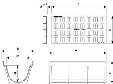
Canal + Tango D4, für mittelmäßigen Verkehr geeignet. Ideal für einen durchschnittlichen täglichen Verkehr von 1.000 bis 20.000, Fahrbahnen, Fußgängerzonen, Seitenstreifen, und Parkplätze für alle Fahrzeugarten.
