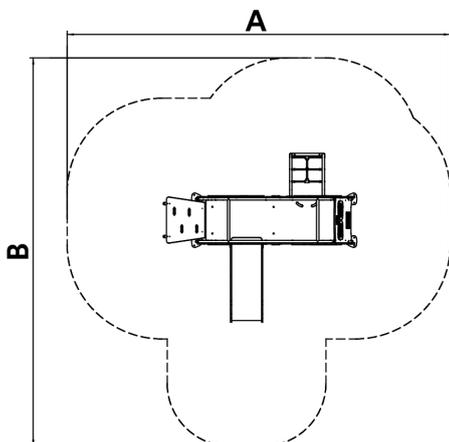
Struktur, Metall: Feuerverzinkte und pulverbeschichtete Pfosten 80x80x2mm sehr witterungsbeständig. Die Rutsche besteht aus poliertem AISI304 Edelstahl in 2 mm Stärke, aus einem Teil gewellt und geformt. Schutzstangen aus AISI304 Edelstahl mit Durchmesser 32mm.
