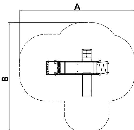
Struktur, Metall: Feuerverzinkte und pulverbeschichtete Pfosten 80x80x2mm sehr witterungsbeständig. Die Rutsche besteht aus poliertem AISI304 Edelstahl in 2 mm Stärke, aus einem Teil gewellt und geformt. Schutzstangen aus AISI304 Edelstahl mit Durchmesser 32mm.
