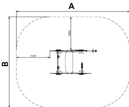
Struktur, Metall: Pfosten mit Durchmesser 35mm aus AISI304 Edelstahl, extrem korrosions- und witterungsbeständig. Die Rutsche besteht aus poliertem AISI304 Edelstahl in 2 mm Stärke, aus einem Teil gewellt und geformt.
