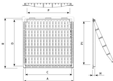
Plana está diseñada para soportar un tráfico suave. Perfecta para instalar en vías con una IMD de 500 a 1.000, especialmente en arceros y cunetas.
