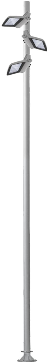
Columna fabricada en acero S-235 JR galvanizada en caliente, con dos posibles formatos: -Hasta 8 m de altura para instalar luminaria TOP con fijación Ø 60mm. - Las cilíndricas de 10 y 12 m única y exclusivamente para instalar proyectores circulares con equipo exterior (albergables en las 3 puertas de servicio disponibles).
