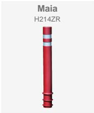
Pilona fabricada en poliuretano, con placa de refuerzo en acero inoxidable. Absorbe cualquier impacto de vehículos y recupera la verticalidad al 100%. Supera una flexión de 1500 ciclos a 45° y 50 ciclos a 90°, sin daños. Clasificación "E" de comportamiento al fuego, según norma UNE-EN 13501-1:2007+A1:2010. Resistente a -50° según norma UNE ISO 812.
