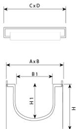
Canal PP RF200/RF300 diseñada para soportar un tráfico medio. Perfecta para instalar en vías con una IMD de 1.000-20.000, especialmente Calzadas de carreteras (incluyendo calles peatonales), arcenes estabilizados y zonas de aparcamiento para todo tipo de vehículos.
