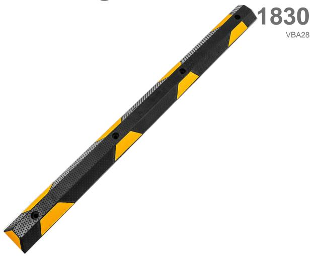
Separador de carril fabricado 100% en caucho reciclado con banda amarilla de caucho integrada en la pieza por vulcanización y con ángulos de ataque frontal y lateral que facilitan la absorción de impactos. Producto ecológico. Respetuoso con el medio ambiente. Fácil instalación, posibilidad de encadenar varios tramos para conseguir la longitud deseada.
