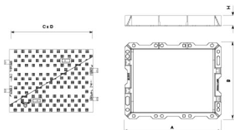
NR1 está diseñada para soportar un tráfico medio. Perfecta para instalar en vías con una IMD de 1.000-20.000, especialmente calzadas de carreteras (incluyendo calles peatonales), arcenes estabilizados y zonas de aparcamiento para todo tipo de vehículos.
