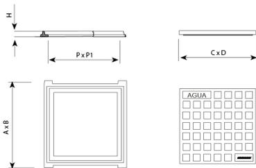
Realizada en fundición dúctil, en gráfico esferoidal, según ISO 1083 (Tipo 500-7) y norma En 1563.
